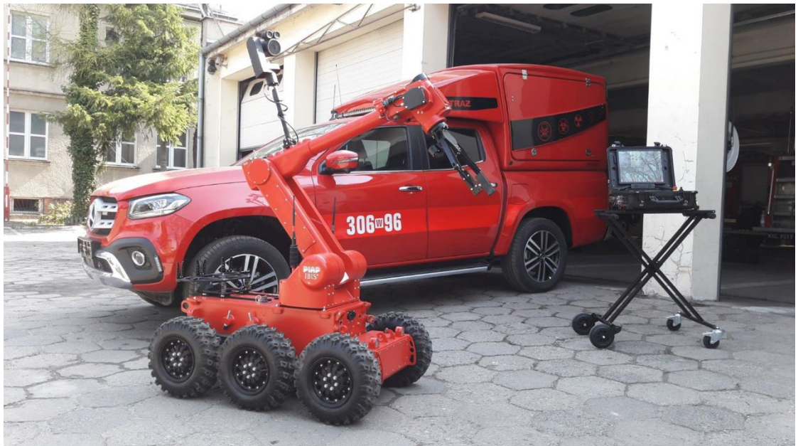
Tunnistuksen erityiskalustoa. Kuvassa kauko-ohjattava robotti.
